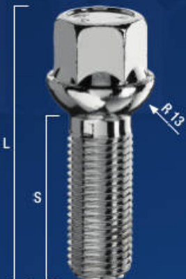
LUG BOLTS M14x1,5 BALL SEAT 17mm HEX
