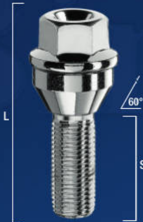
LUG BOLTS M14x1,5 CONE SEAT 19mm HEX
